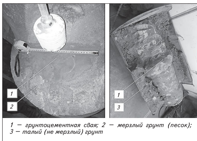
Рис. 4. Результаты вскрытия лотков после проведения испытаний
