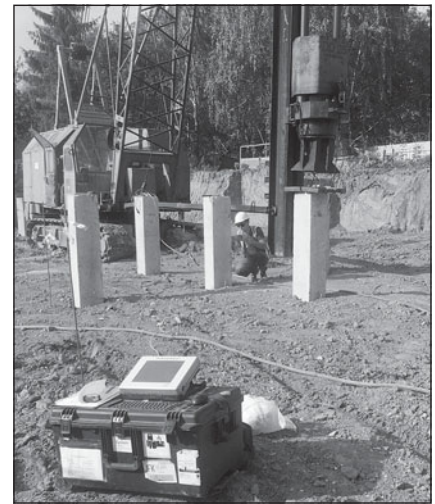
Рис. 2. Комплект оборудования Pile Driving Analyzer (PDA-8G) и процесс установки датчиков при проведении испытаний
