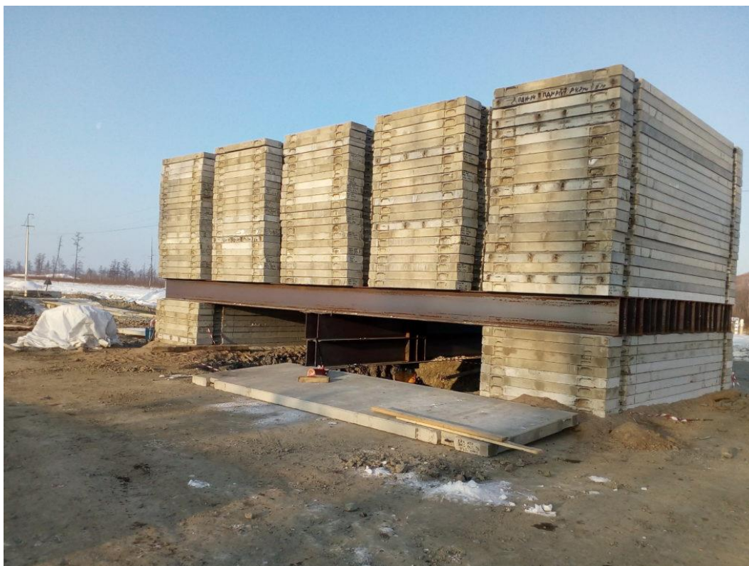
Стенд для проведения испытаний нагрузкой до 400 тс с контргрузом, Хабаровский край
